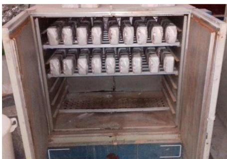
Figura 41 - Blocos sendo curados a 40 +/- 1°C.
