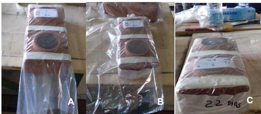
Figura 32- Saco Polietileno (A); Saco PET sobre o de polietileno (B); Embalagem dupla finalizada (C).
