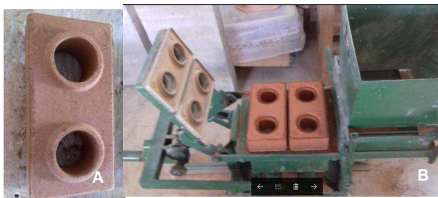
Figura 30 – Bloco (A); Prensa manual de blocos (B).
