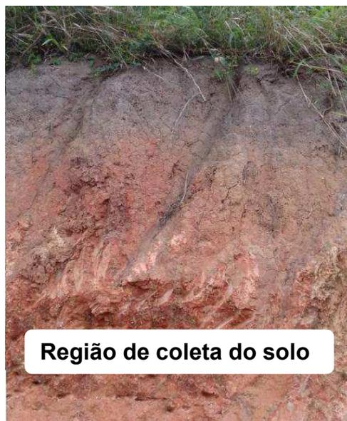
Figura 8 – Coleta do solo a 2,5m de profundidade.
