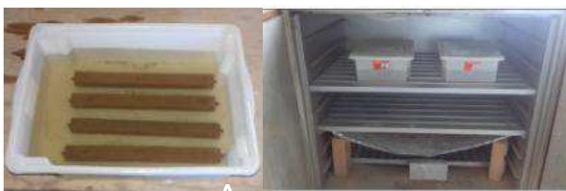
Figura 50 – Barras de argamassa em solução agressiva (A) e na estufa a 80°C (B)
