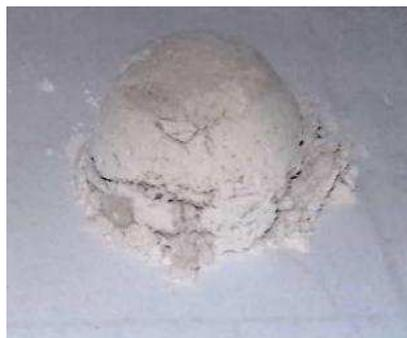
Figura 17- Cinza calcinada com partículas desagregadas.
