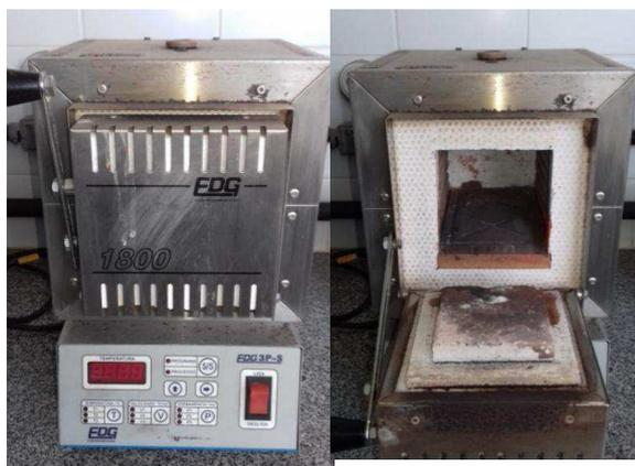
Figura 13 – Forno tipo Mufla EDG.
