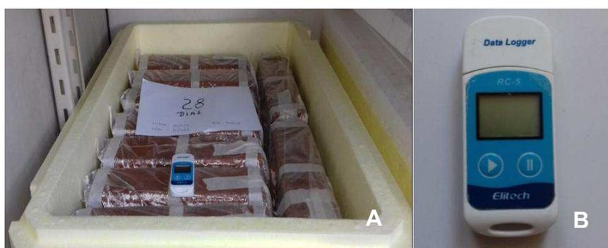
Figura 37 - Acondicionamento dos blocos (A); Registrador de temperatura (B)
