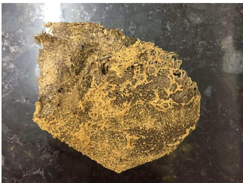
Figura 28 – Membrana de SPEEK seca à 100 °C por 15 min.
