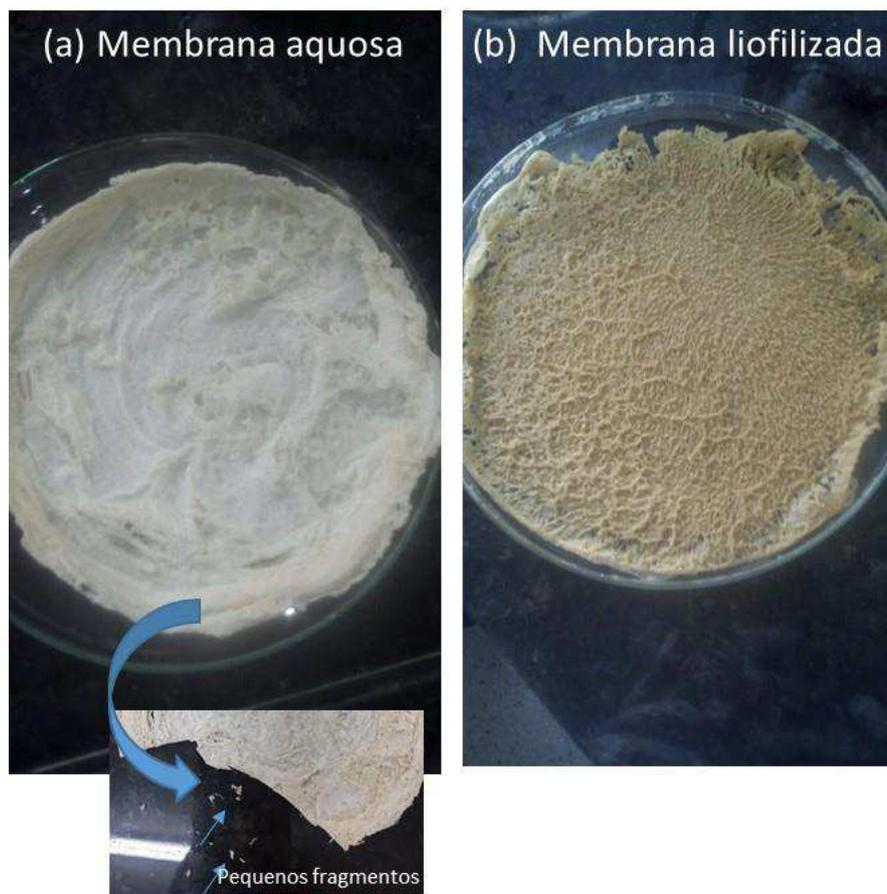
Figura 21 – Membranas (a) aquosa (b) liofilizada.
