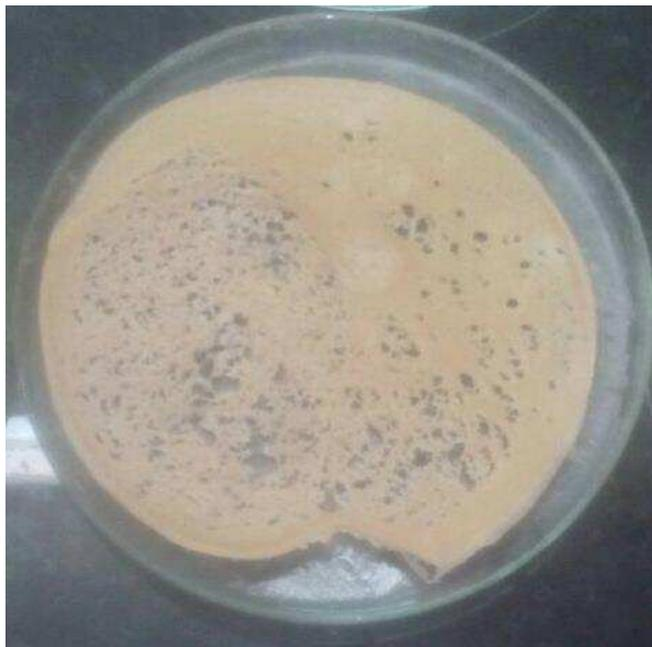
Figura 29 – Membrana de SPEEK seca à 50 °C por 3 h.
