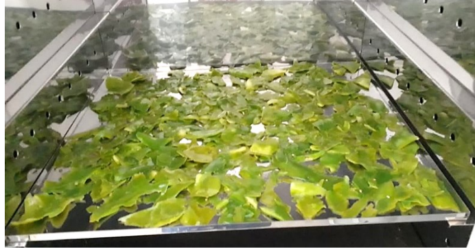
Fotografia 3 - Cascas de palma forrageira ( Opuntia ficus ) dispostas em bandeja para secagem convectiva.
