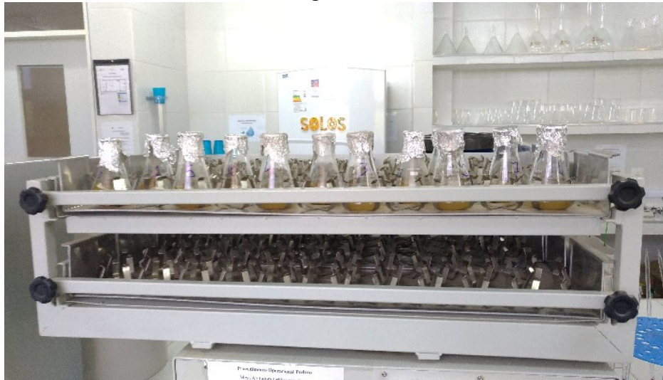
Fotografia 5 - Frascos Erlenmeyer contendo a mistura água/gasolina/biomassa na mesa agitadora.
