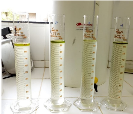
Fotografia 9 - Análise volumétrica da quantidade de gasolina adsorvida no processo.
