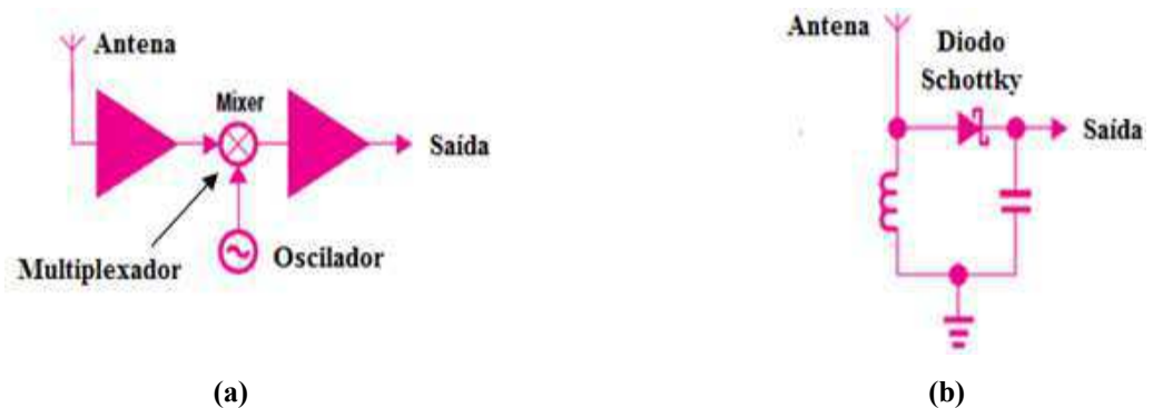
Figura 1 – (a) Receptor super-heteródino (b) Receptor Crystal vídeo
