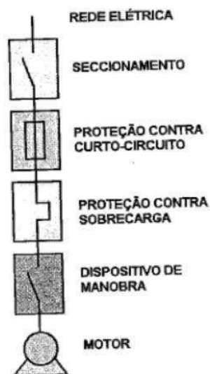
Figura 1 – Sequência genérica para o acionamento de um motor. [1]
