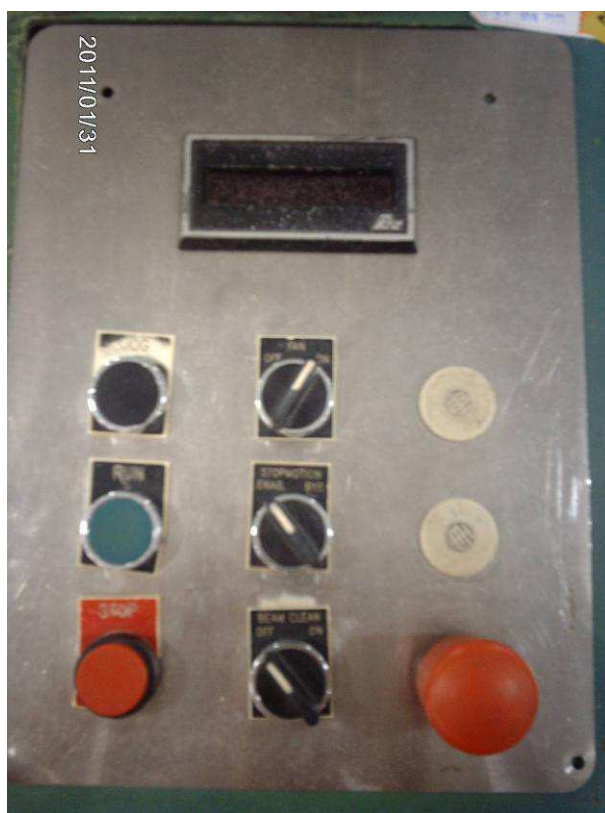
Figura 3 – Painel de operação com botoeiras e chaves.
