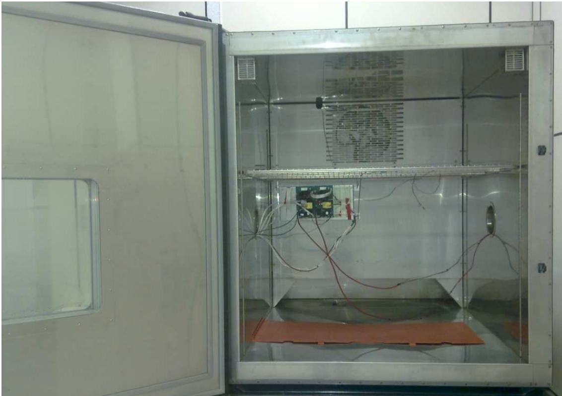
Figura 39. Cartão de fonte chaveada para alimentação de ventiladores dentro da câmara climática.
