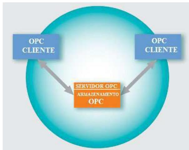
Figura 2: Esquema de Comunicação entre Clientes e Servidor Utilizando OPC
