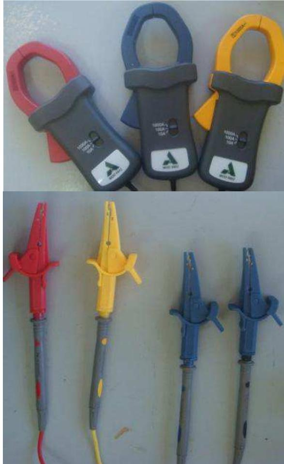
**Figura 2 - Alicates e grampos utilizados pelo analisador para aquisição de dados.**
