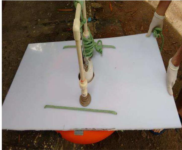
**Figura 8:** Sonda multiparâmetros acoplada a boi náutica.
