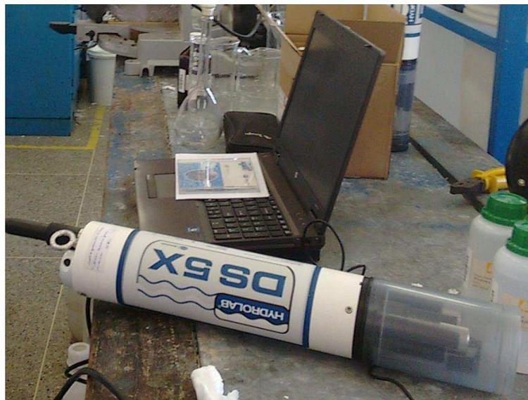
**Figura 7:** Sonda DS5X e protetor de sensores.
