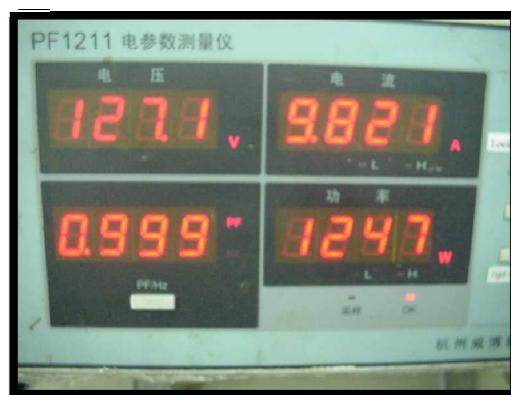
Figura 8: Leitura do wattímetro para o ferro clássico
