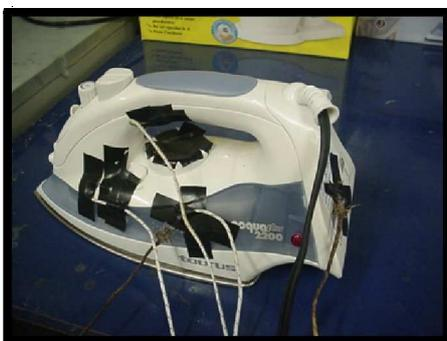
Figura 11: Pontos medidos da temperatura do ferro
