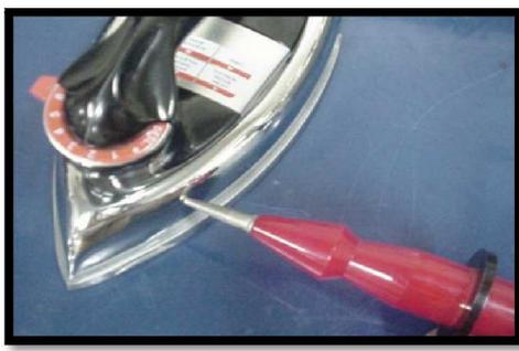
Figura 15: Ponta de prova do highpot
