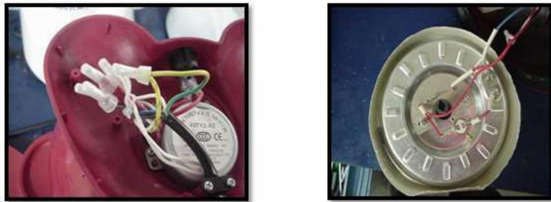
Figura 18: Fiação interna da pipeteira
