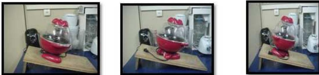
Figura 16: Pipoqueira em um plano inclinado no ensaio de estabilidade
