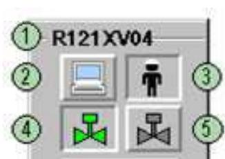
Figura 42 – Exemplo da tela de operação de uma válvula "on-off"
