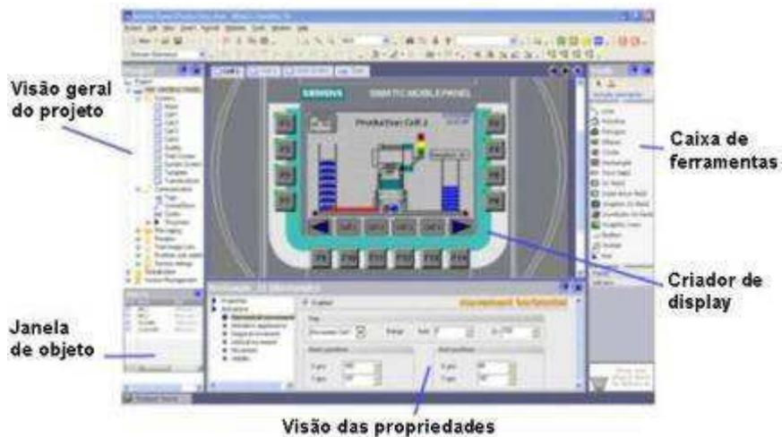
Figura 27 - Componentes do software *WinCC flexible*
