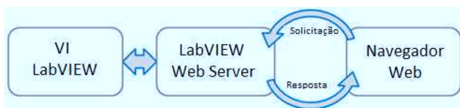
Figura 2.3: Fluxo de dados entre o servidor que roda o VI no LabVIEW e o cliente que solicita o VI pelo navegador Web ( National Instruments, 2011c )
