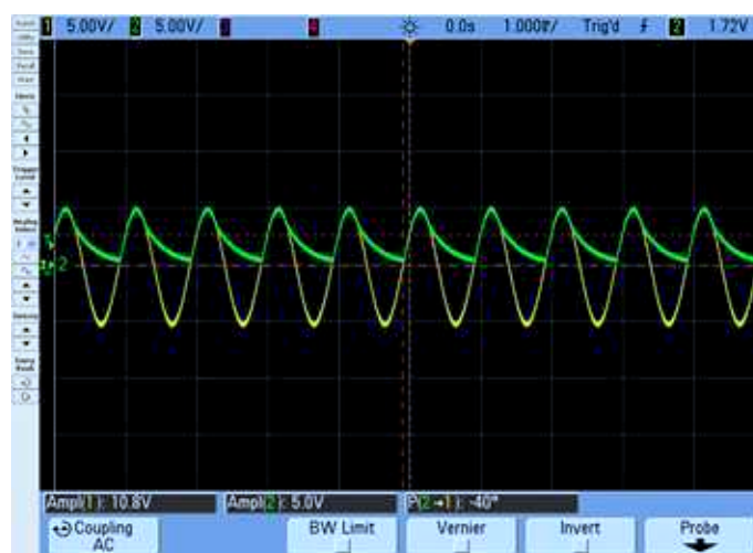
Figura 4.10: Sinal de entrada em 1kHz na cor amarela e sinal de saída na cor verde
