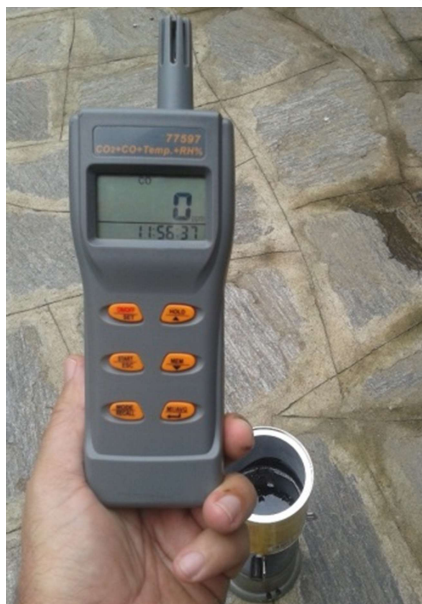
Figura 36 - Uso do Medidor Portátil Multifuncional Modelo ITMCO 2 – 600, no experimento
