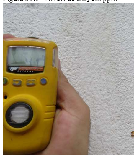
Figura 35A – Uso do Detector de SO 2 , no experimento
