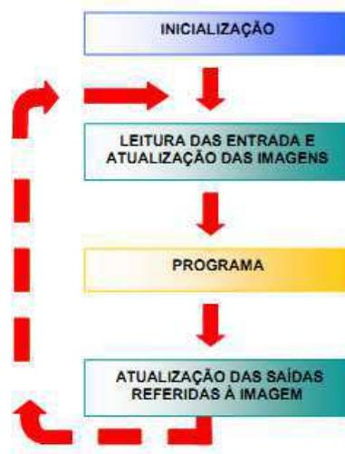
**Figura 3:** Ciclo de processamento do CLP [4].
