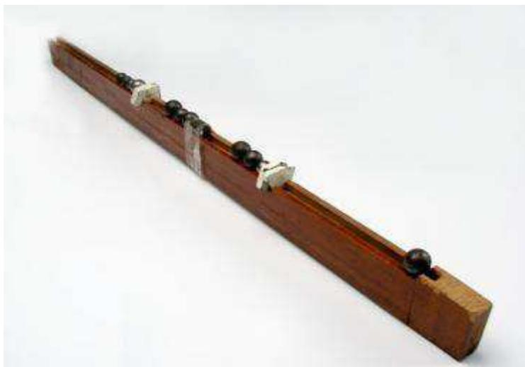
Figura 6: Arranjo final do experimento "Canhão de Gauss"
