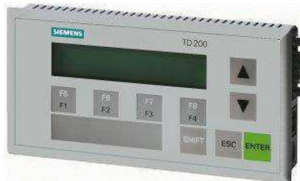
Figura 5: Interface Homem-Máquina
