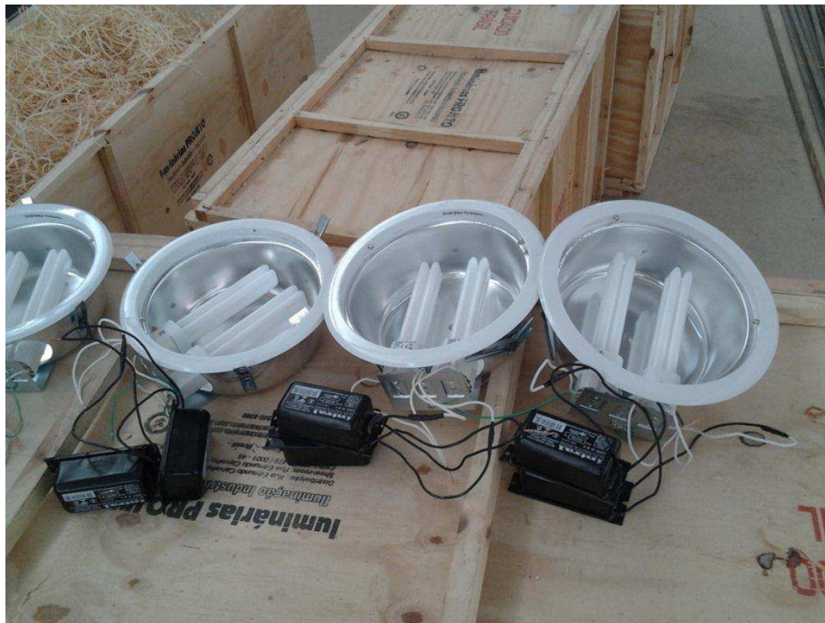
Figura 10 - Luminárias de embutir compactas.
