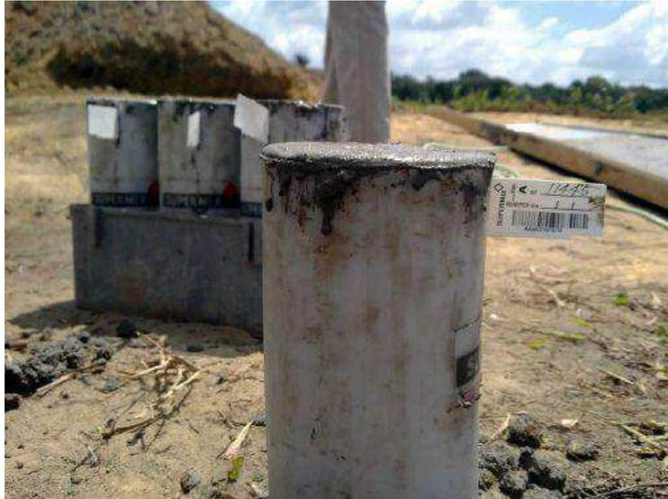
Figura 23: Detalhe dos corpos de prova moldados durante a aplicação do concreto na fundação da estrutura 13/4.
