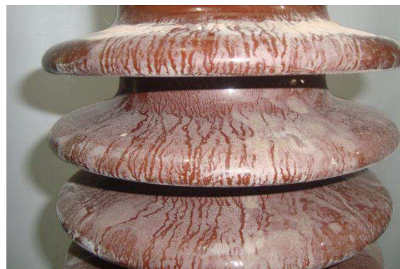
Figura 11 - Para-raios borrifado com solução salina
