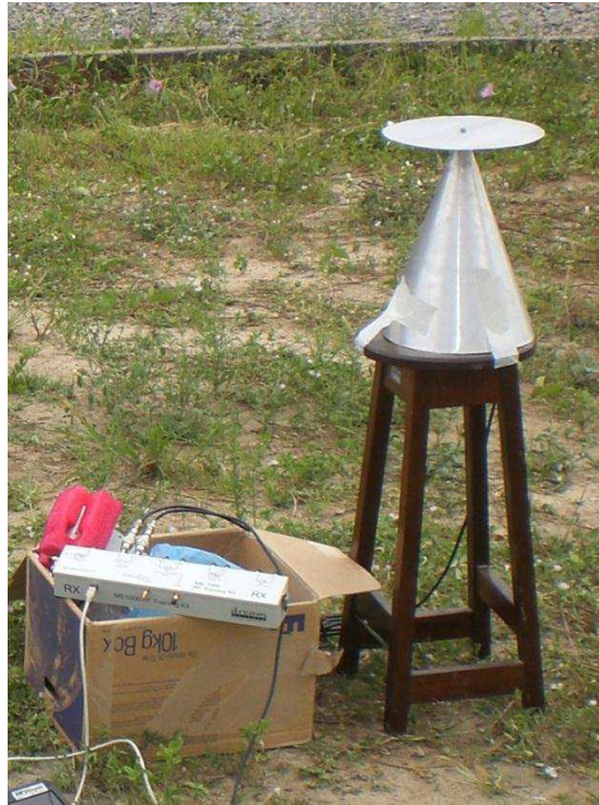
Figura 24 - LNA (à esquerda) e antena Discone
