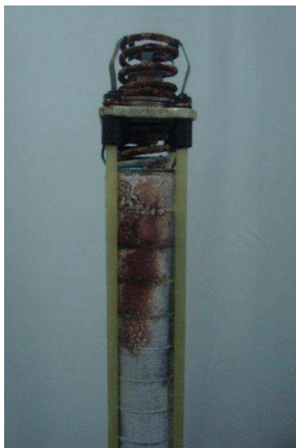
Figura 13 - Pastilhas de ZnO do para-raios
