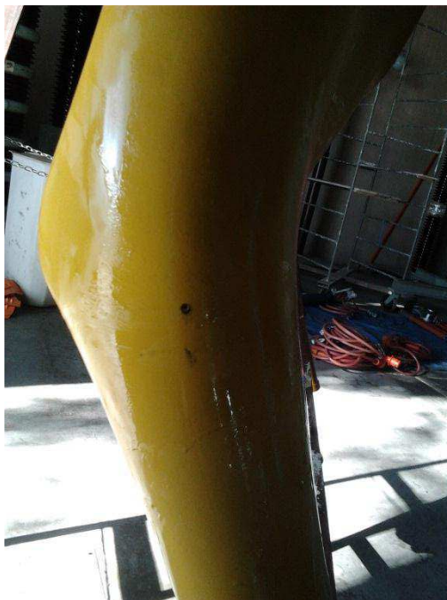
Figura 9 - Manga isolante reprovada. Nota-se ponto carbonizado devido a defeito de isolamento.
