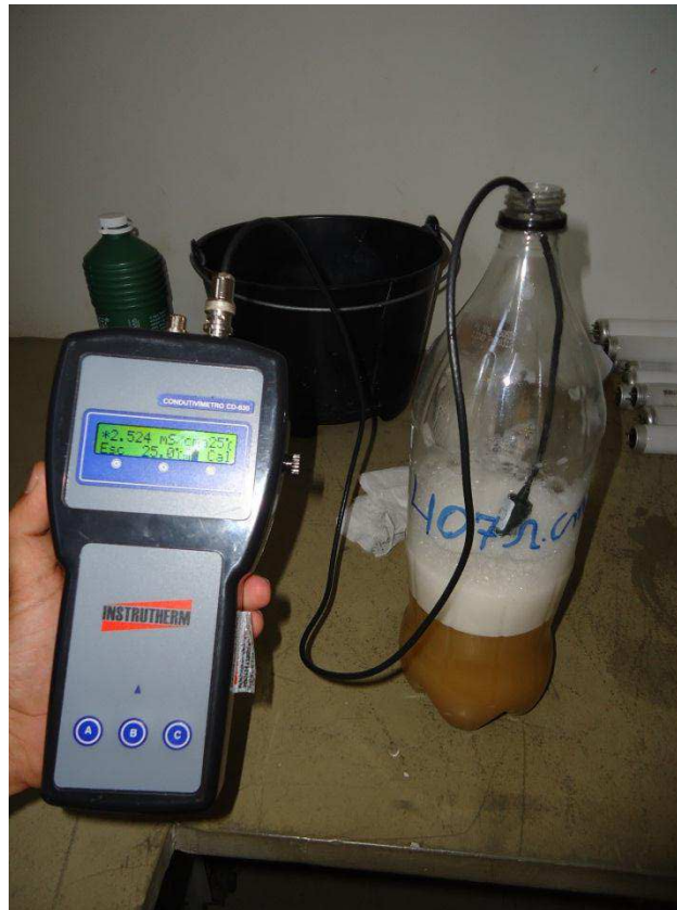
Figura 10 - Condutivímetro (esquerda) e solução salina (direita) com bauxita
