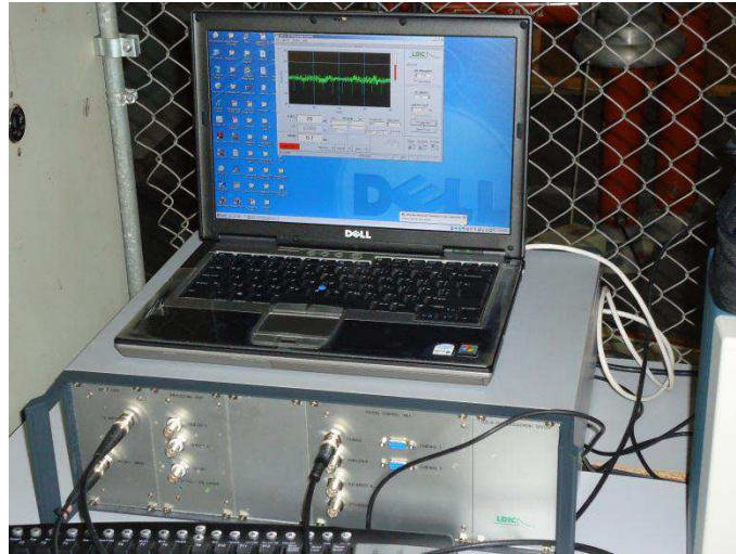
Figura 17 - Software LDS-6 no notebook que está sobre o detector de DP
