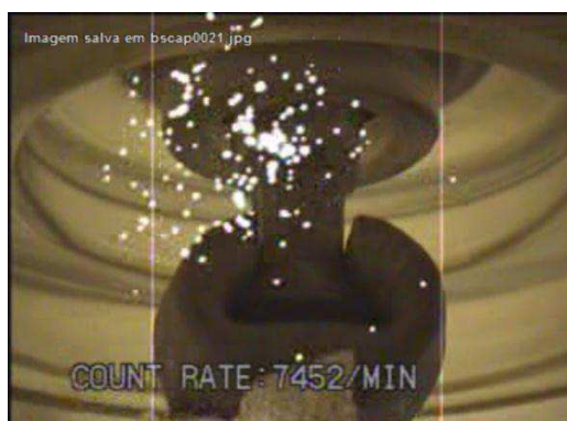
Figura 23. Imagem da câmara ultravioleta em um isolador antes da névoa.
