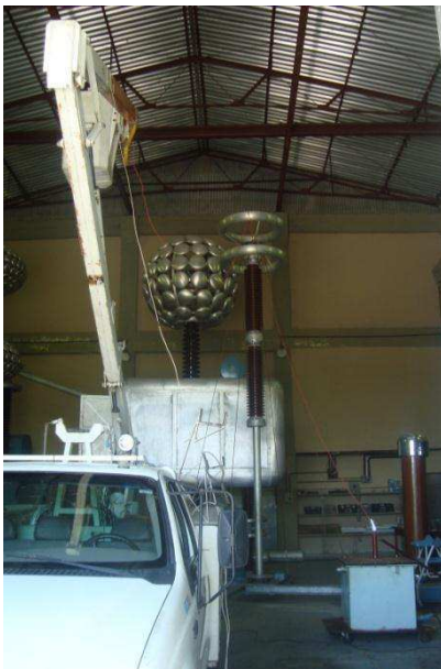
Figura 29. Fotografia do ensaio em cesta aérea.
