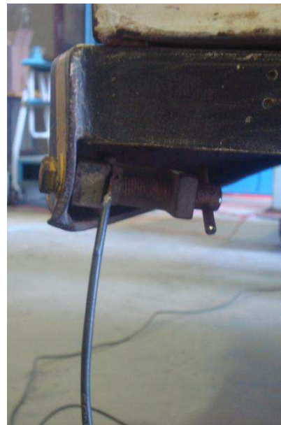
Figura 30. Detalhe do aterramento do chasis do caminhão.
