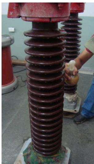
Figura 9. Poluição sendo borrifada sobre o invólucro.
