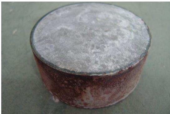
Figura 13. Varistor degradado pelo efeito da umidade.
