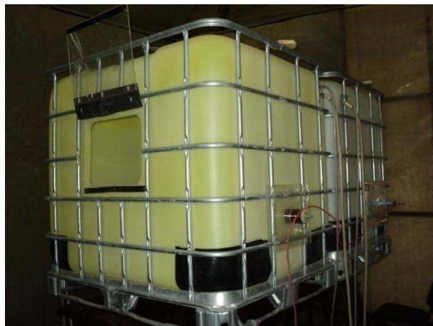
Figura 19. Reservatórios adaptados para funcionarem como câmaras de névoa.
