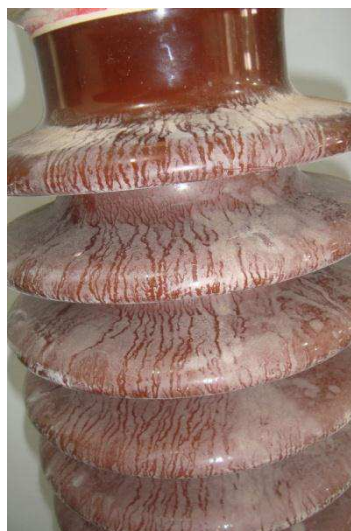
Figura 10. Poluição na superfície do invólucro de porcelana do para-raios.
