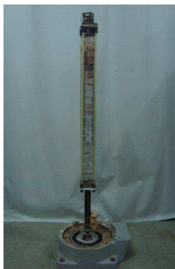
Figura 12. Coluna de varistores do para-raios PR10.
