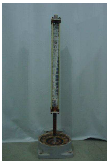
Figura 11. Coluna de varistores do para-raios PR9.
