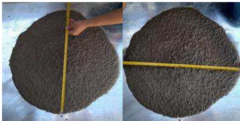
Figura 12 - Medição do diâmetro de espalhamento (Autor, 2020)
