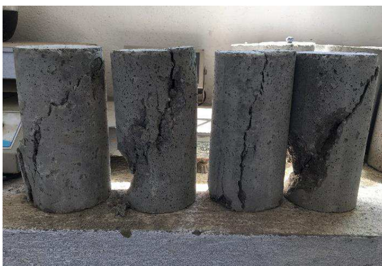
Figura 27 – Corpos de prova do TRV15 após o ensaio de resistência à compressão
