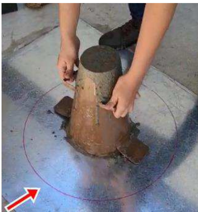
Figura 10 - Marca de 500 mm na placa-base do slump flow (Autor, 2020)
