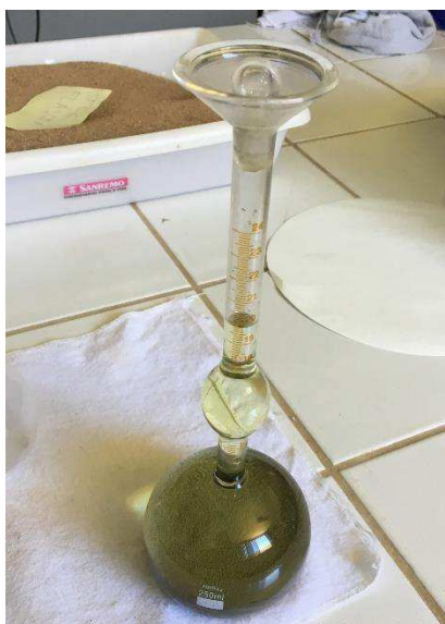
Figura 5 - Ensaio de massa específica do cimento (Autor, 2020).
