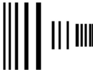
Figura 10 – Código de barras RF. As linhas de variados tamanhos têm frequências de ressonância diferentes e a codificação é feita a partir da presença ou ausência das fitas metálicas de frequências específicas (JALALY, 2005).
