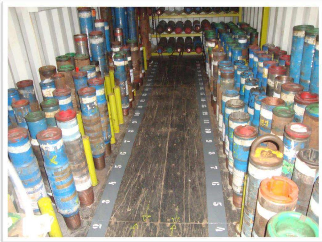
**Figura 36: Container de armazenamento de Crossover**
