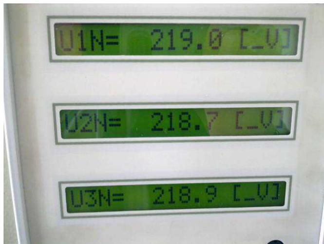
Figura 16: Medida de tensão na entrada do painel.
