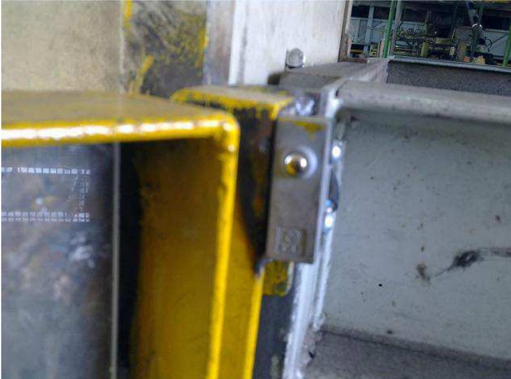
Figura 22: Posicionamento de uma das chaves fim de curso da máquina de lingotar.
