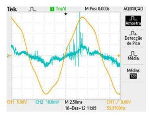
Figura 37. Medição de corrente de fuga de um fio de nylon novo e limpo.
