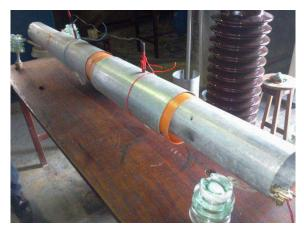
Figura 7. Fotografia do ensaio em coberturas circulares.
