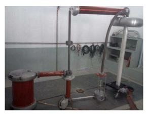
Figura 23. Fotografia da montagem feita para realização de medição de descargas parciais.
