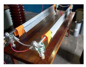
Figura 4. Fotografia do ensaio em coberturas rígidas para condutores.
