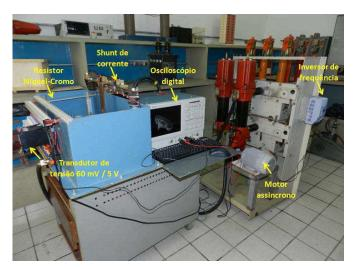
Figura 28. Fotografia da montagem para realização de ensaios de MRDC.
