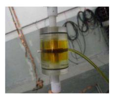
Figura 22. Fotografia da célula de acrílico preenchida com óleo mineral isolante [6].
