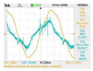
Figura 35. Medição de corrente de fuga de um bastão de 51 mm de diâmetro limpo.
