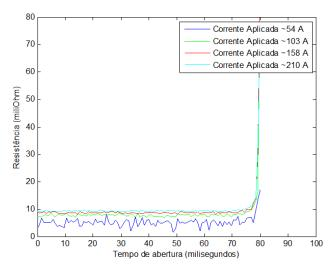
Figura 31. Curvas de resistência dinâmica para velocidade de abertura nominal.
