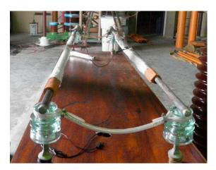
Figura 5. Fotografia do ensaio em coberturas flexíveis para condutores.
