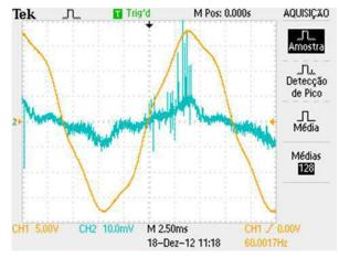
Figura 38. Medição de corrente de fuga de um fio de nylon novo e sujo.
