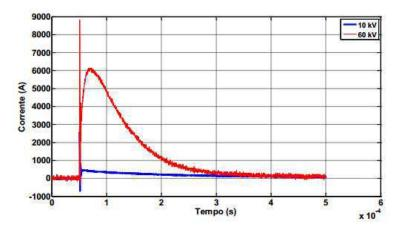
Figura 27. Formas de onda de corrente na haste de aterramento para tensões de carregamento de 10e 60 kV [4].
