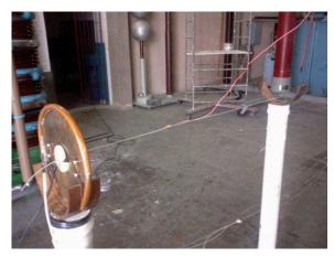
Figura 34. Fotografia do ensaio em linhas de mão isolantes feitas de nylon.
