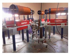
Figura 24. Fotografia do gerador de impulso de corrente.
