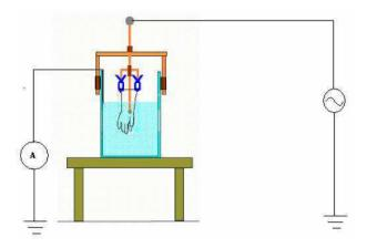
Figura 12. Esquema de montagem para ensaios em luvas isolantes [5].
