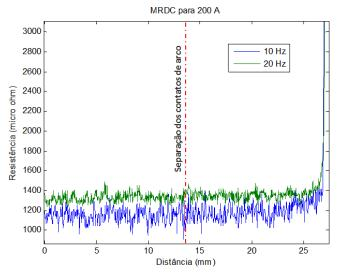
Figura 32. Curvas de resistência dinâmica para aberturas de contatos com 10 e 20 Hz.
