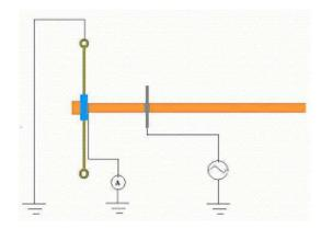
Figura 20. Esquema de montagem para ensaios em bastões de manobra [5].
