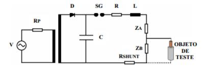
Figura 26. Esquema de montagem usado para ensaios em hastes de aterramento [4].
