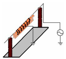
Figura 3. Esquema de montagem para ensaios de coberturas para condutores do tipo rígida [5].
