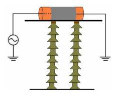
Figura 6. Esquema de montagem para ensaios de coberturas circulares [5].
