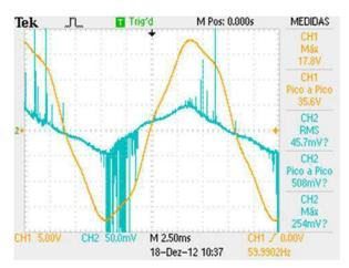
Figura 36. Medição de corrente de fuga de um bastão de 51 mm de diâmetro sujo.
