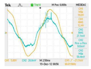
Figura 40. Medição de corrente de fuga de um fio de nylon com cinco intervenções.
