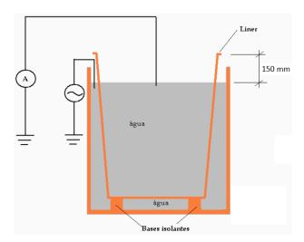
Figura 9. Esquema de montagem para ensaios em cubas isolantes [5].
