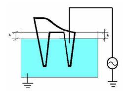
Figura 14. Esquema de montagem para ensaio em mangas isolantes [5].
