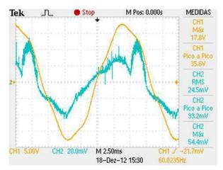
Figura 39. Medição de corrente de fuga de um fio de nylon com uma intervenção.
