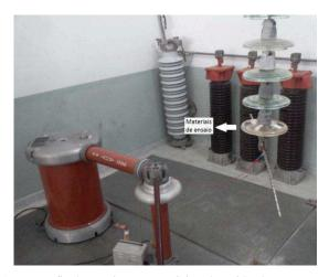
Figura 41. Fotografia do ensaio em materiais submetidos à um campo elétrico.
