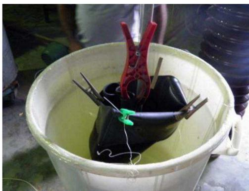
Figura 15. Fotografia do ensaio em manga isolante.
