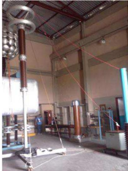
Figura 2. Fotografia do transformador e do divisor de tensão capacitivo.
