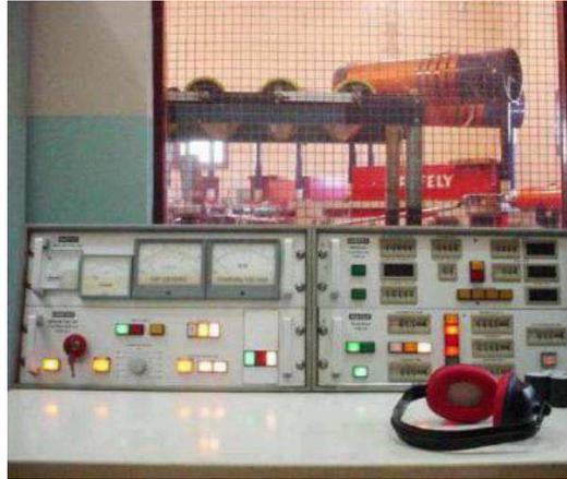
Figura 25. Fotografia da mesa de controle do gerador de impulso de corrente.
