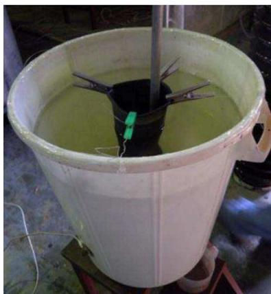
Figura 13. Fotografia do ensaio em luva isolante.
