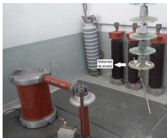
Figura 41. Fotografia do ensaio em materiais submetidos à um campo elétrico.
