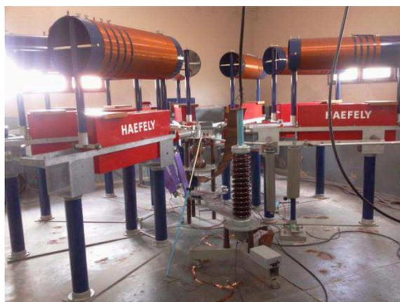
Figura 24. Fotografia do gerador de impulso de corrente.
