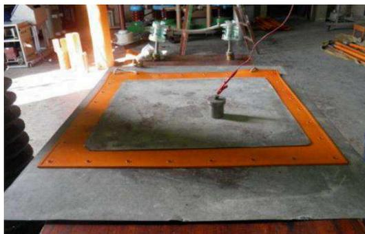
Figura 17. Fotografia do ensaio em lençol isolante inteiro.
