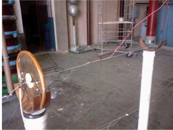
Figura 34. Fotografia do ensaio em linhas de mão isolantes feitas de nylon.
