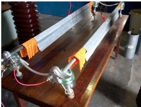
Figura 4. Fotografia do ensaio em coberturas rígidas para condutores.
