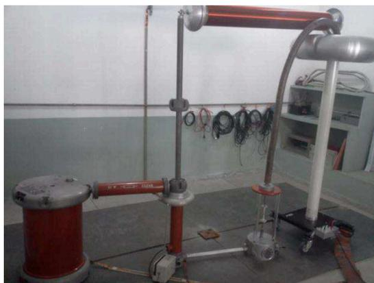
Figura 23. Fotografia da montagem feita para realização de medição de descargas parciais.
