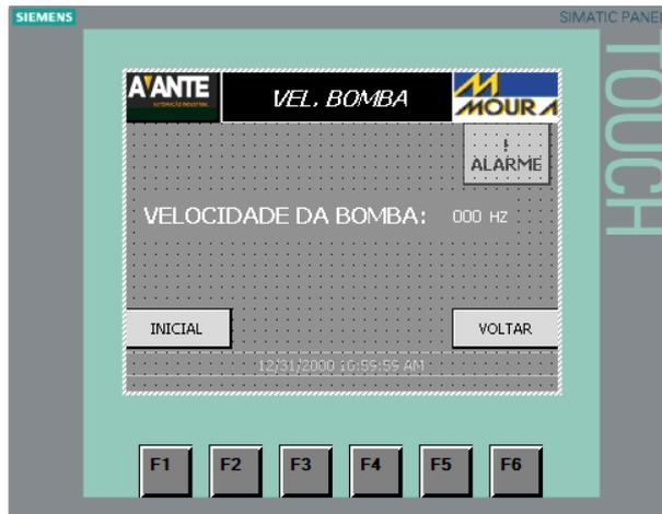
Figura 28: Tela de set-point do valor de rotação da bomba.
