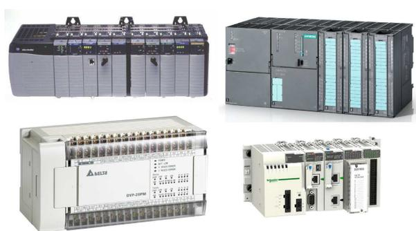
Figura 41: Exemplos de CLP de diversos fabricantes.
