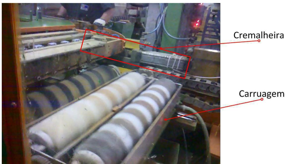
Figura 11: Fotografia do segundo estágio (escova) da máquina TBS.
