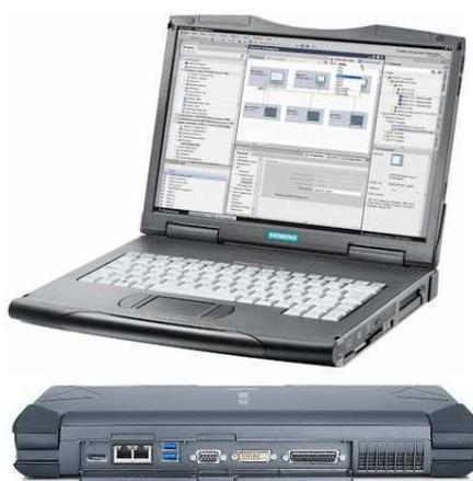
Figura 48: Exemplo de uma SIMATIC PG.
