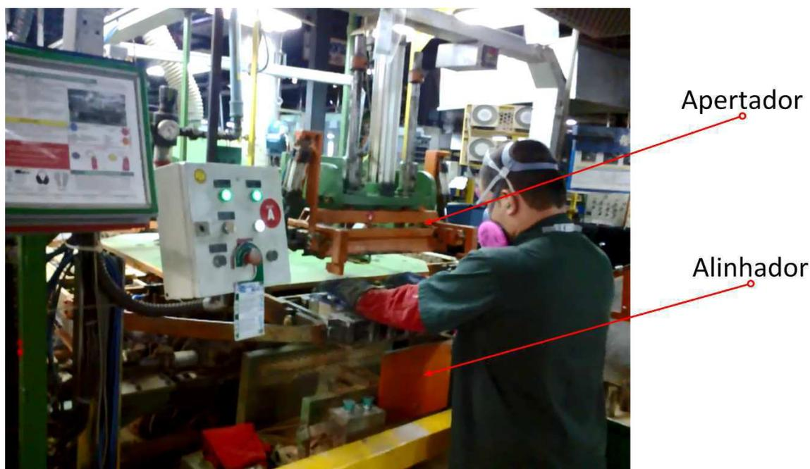
Figura 9: Fotografia do primeiro setor (alinhador/apertador) da máquina TBS.
