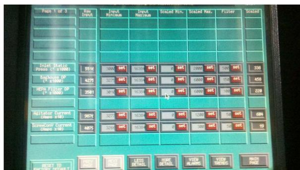
Figura 33: Escalonamento das entradas analógicas através da IHM.
