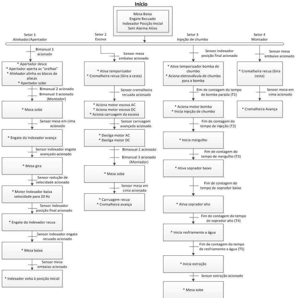
Figura 6: Diagrama sequencial de operação da máquina TBS.
