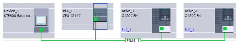
Figura 21: Estrutura de rede para o projeto desenvolvido para a máquina TBS da Moura.
