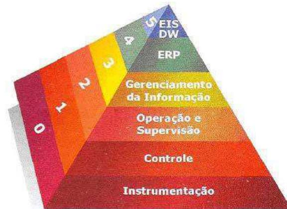
Figura 21. Níveis hierárquicos de um processo industrial.
