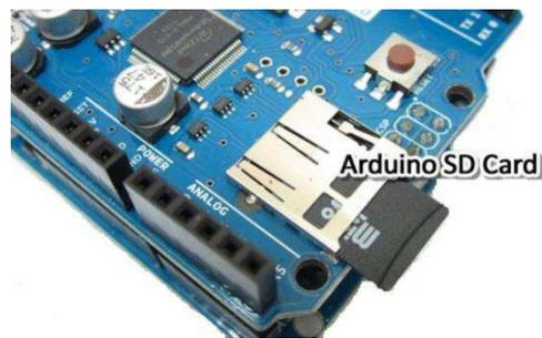
Figura 27. Método de Identificação da placa através de Micro SDcard.
