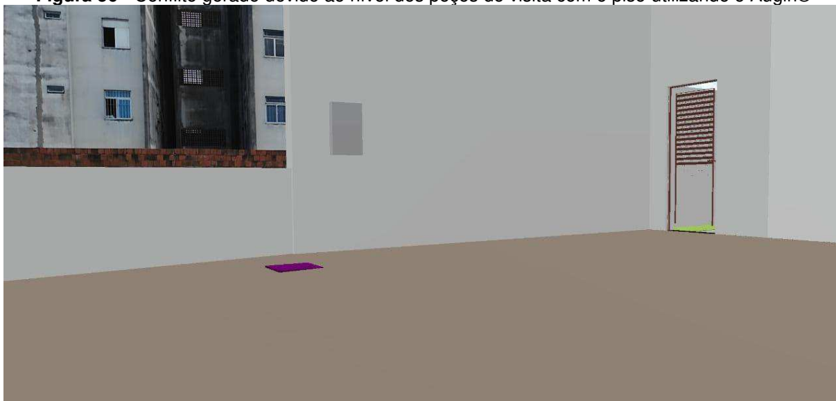
Figura 56 - Conflito gerado devido ao nível dos poços de visita com o piso utilizando o Augin®
