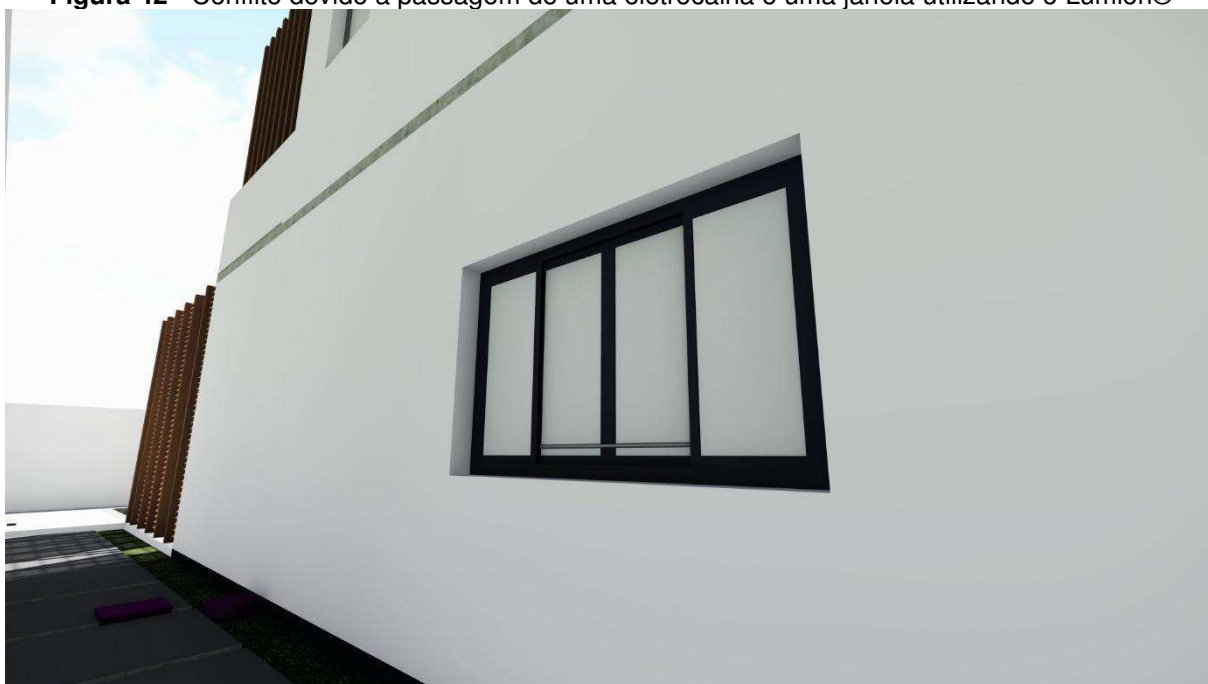
Figura 42 - Conflito devido a passagem de uma eletrocalha e uma janela utilizando o Lumion®
