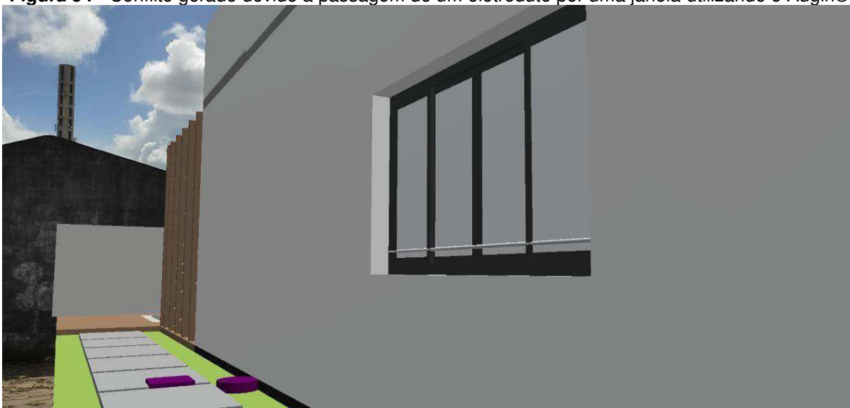
Figura 54 - Conflito gerado devido a passagem de um eletroduto por uma janela utilizando o Augin®
