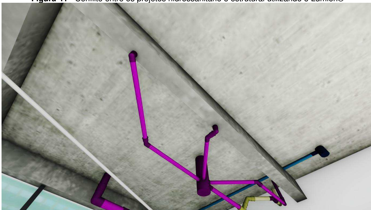
Figura 41 - Conflito entre os projetos hidrossanitário e estrutural utilizando o Lumion®
