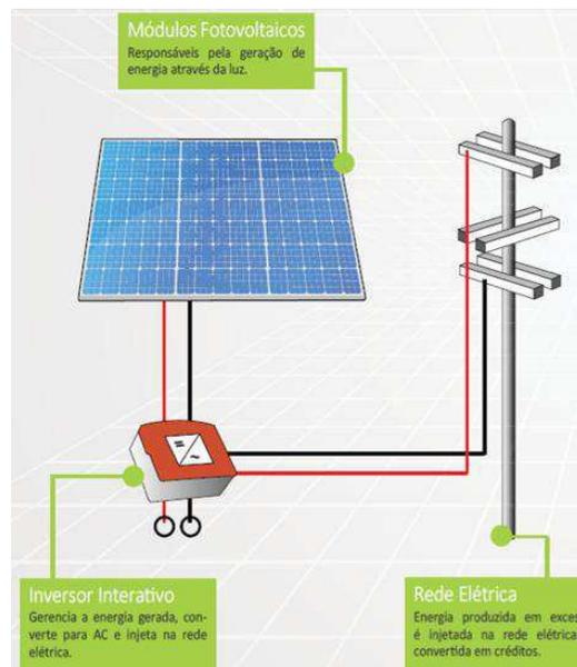
Figura 11: Componentes de um sistema fotovoltaico conectado à rede.
