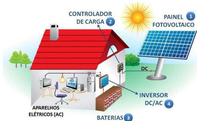
Figura 8: Sistema de energia solar fotovoltaica autônomo. Fonte: [www.neosolar.com.br](http://www.neosolar.com.br).
