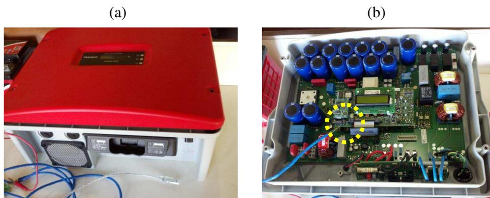
Figura 16: (a) Inversor fotovoltaico SUNNY BOY 3800; (b) Interior do inversor, com destaque na comunicação serial. Fonte: Arquivo pessoal.
