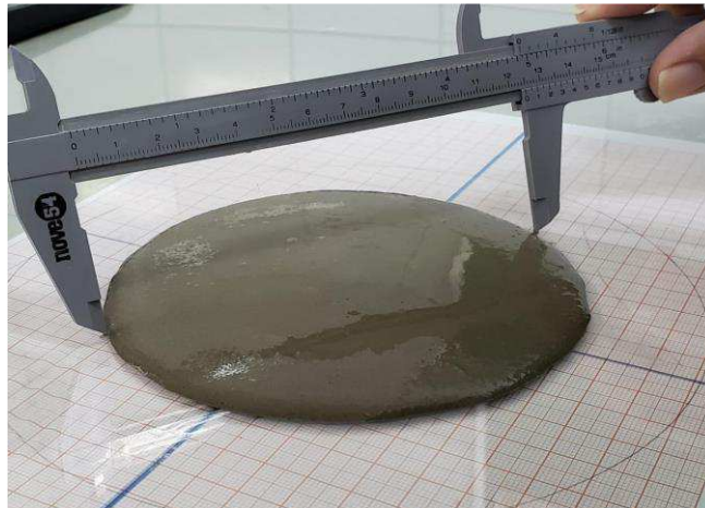
Figura 18 - Medição do espalhamento da argamassa
