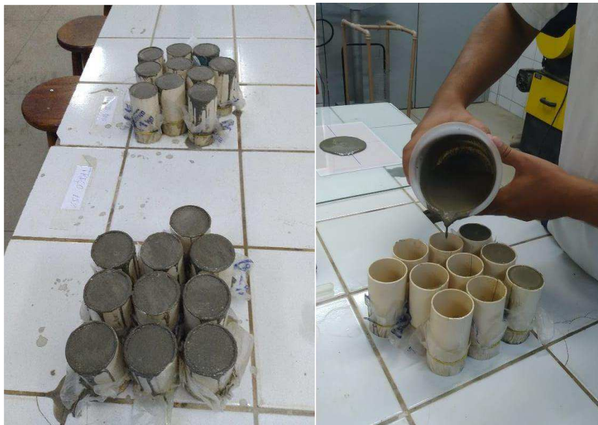
Figura 19 - Moldagem dos corpos de prova
