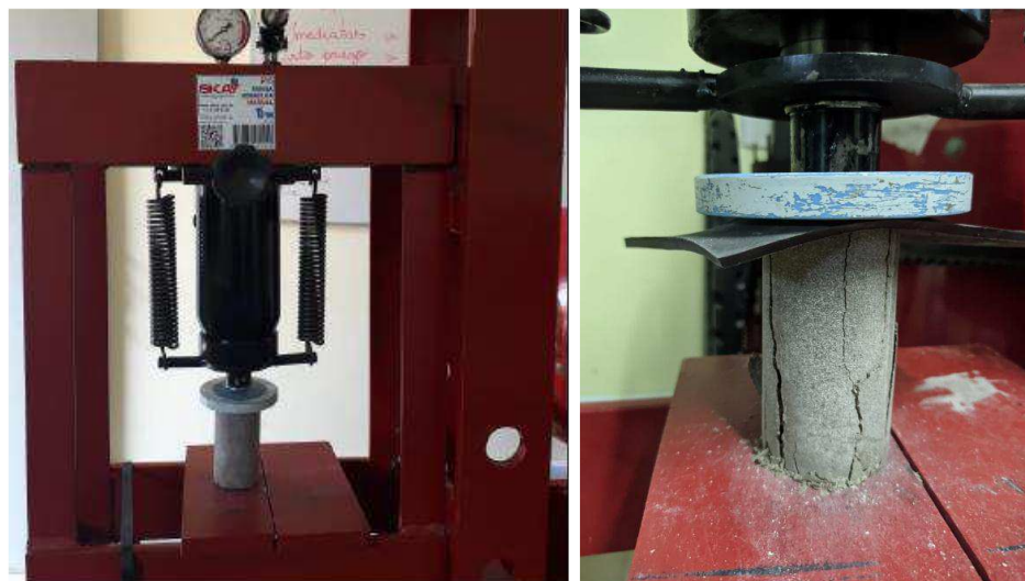
Figura 21 – (a) Ensaio de resistência à compressão; (b) Corpo de prova rompido
