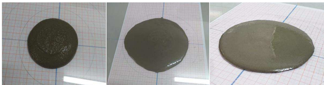
Figura 17 – (a)Argamassa sem escoamento;(b)Argamassa exsudada;(c)Argamassa ótima
