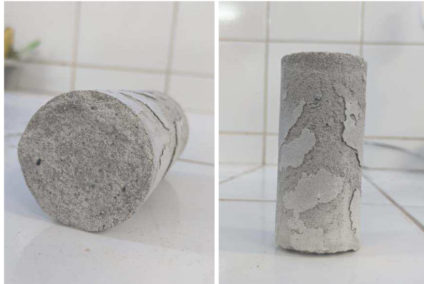
Figura 20 - Corpos de prova danificados
