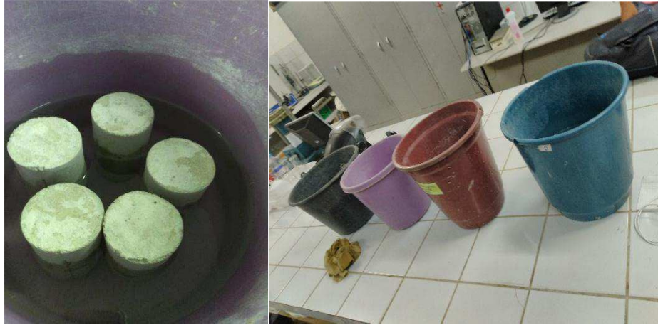
Figura 22 - Corpos de prova na cura úmida com 2/3 do volume imersos
