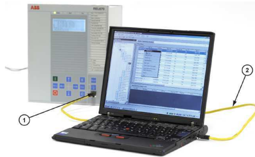
Figura 9: Comunicação com o RED 670 - 1: Porta de comunicação serial do IED com conector RJ45; 2: Cabo ethernet com conector RJ45.
