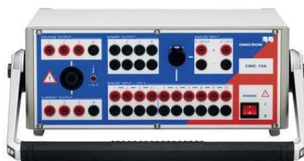
Figura 18: Mala de testes CMC 156 - Omicron.
