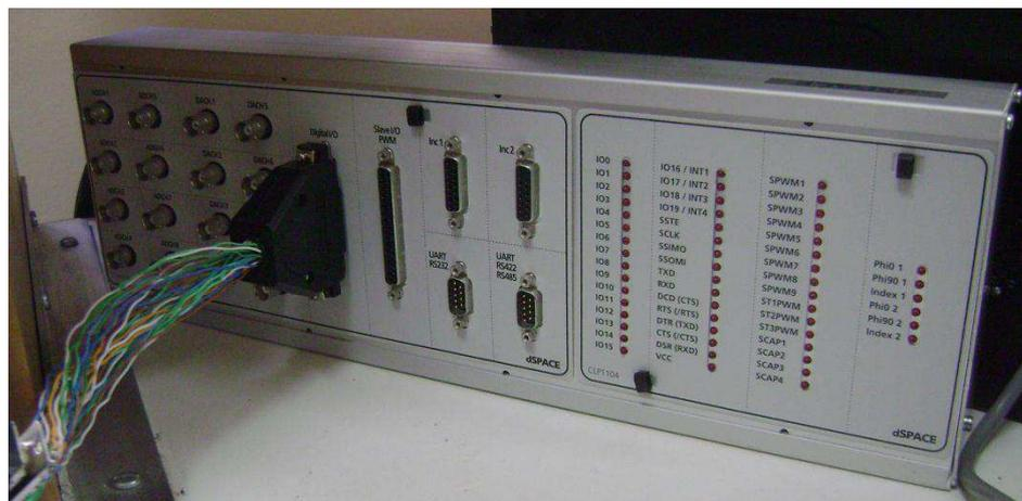
Figura 24: Foto do simulador dSPACE utilizado para gerar os sinais de chaveamento a partir da modulação específica.
