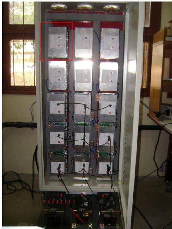
Figura 19: Foto da bancada experimental de um inversor de até onze níveis.
