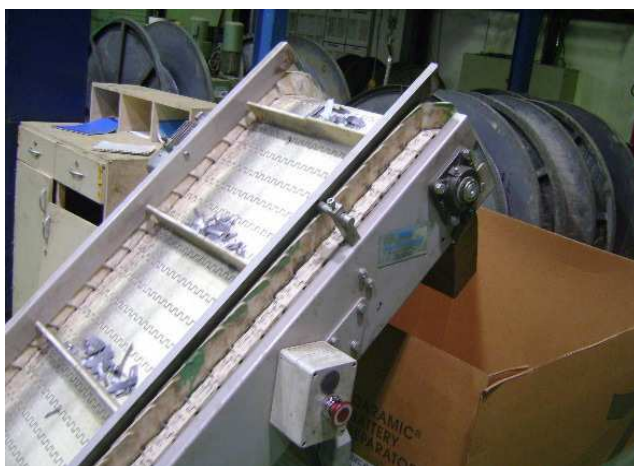
Figura 12. Vista das rebarbas sendo armazenadas em um único recipiente. Fonte: Imagem própria, Brasil, 2012.
