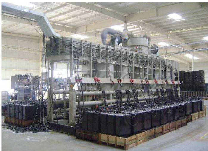
Figura 18. Foto do equipamento Inbatec para a formação controlada. Fonte: Imagem própria, Brasil, 2012.
