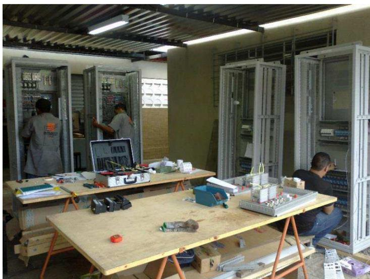
Figura 23 – Processo de construção dos chassis de proteção da 05L8 na oficina da Interest.
