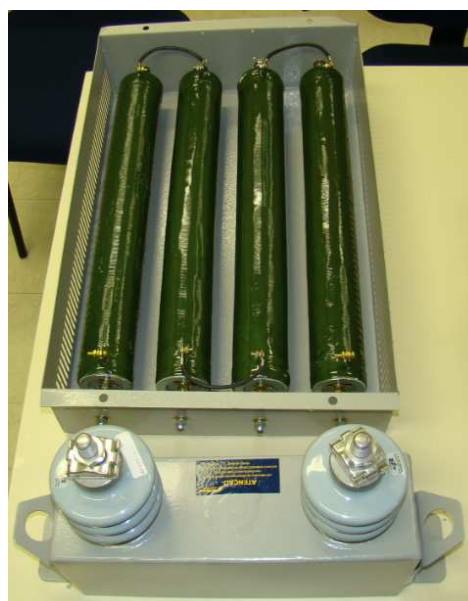
Figura 3.46 Resistores e capacitor do filtro RCD modificado.
