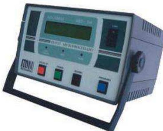
Figura 14 – Foto do instrumento para medição da resistência de isolamento (Modelo B).
