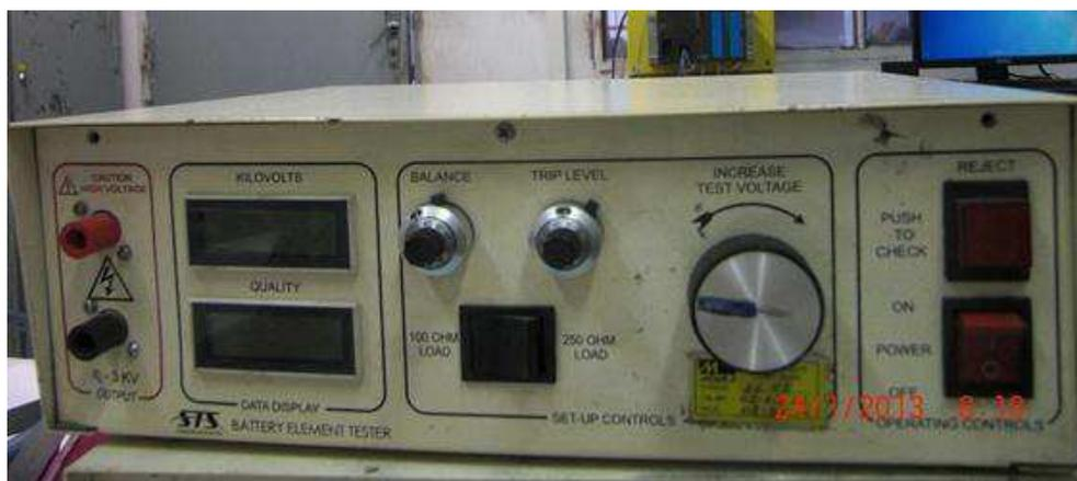
Figura 13 – Foto do instrumento para medição da resistência de isolamento (Modelo A).
