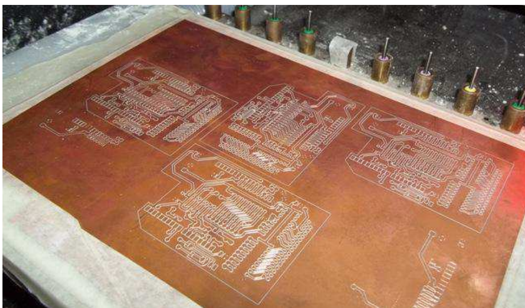
Figura 19 – Placa de Fenolite utilizada pela Fresa CNC para confecção das PCIs.
