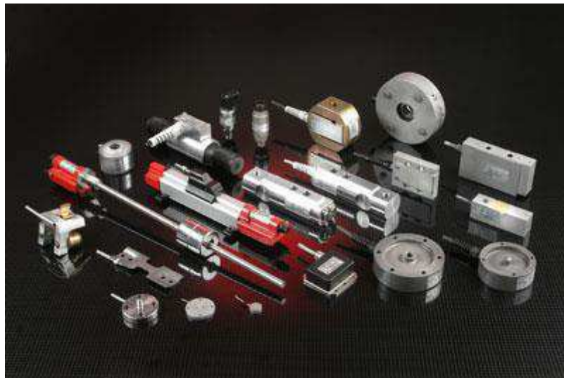
Figura 3 - Exemplos de transdutores utilizados na unidade de aquisição de dados. (SPACMAN, 2013)
