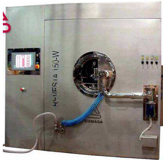
Figura 14 - Revestidora de comprimidos semelhante a máquinas em manutenção.
