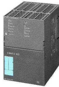
Figura 11 - Communication Processor de comunicação para o estabelecimento da conexão Industrial Ethernet.
