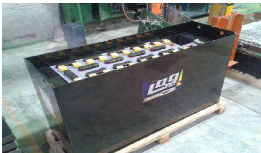
Figura 9: Montagem de Bateria Tractionaria
