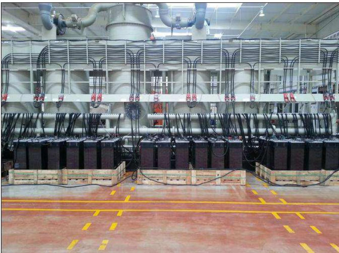
Figura 14 – Máquina utilizada para circulação de solução - Inbatec
