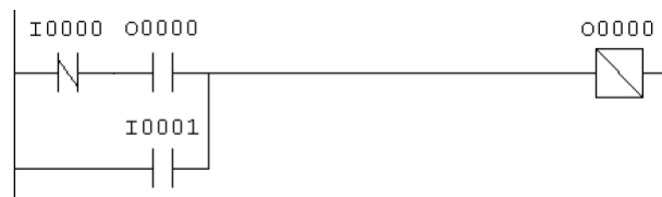
Figura 21: Diagrama Ladder de uma partida direta com prioridade no ligamento
