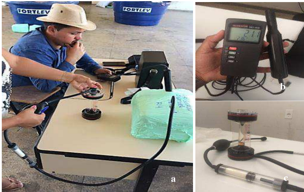
Figura 4. Medição dos gases, O 2 , CO 2 e temperatura do pré-secado. a- Medição dos gases; b- INSTRUTHERN (modelo MO-900); c- TESTORYT. Fonte: Próprio Autor (2018)
