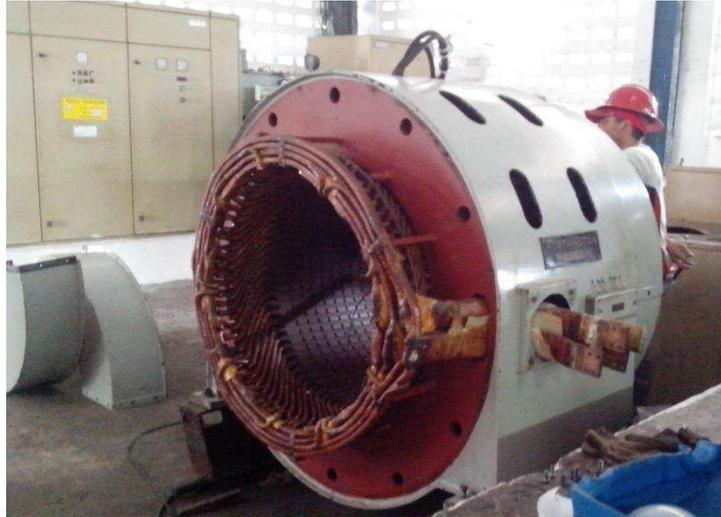
**Figura 3 – Bobinado do estator do gerador síncrono trifásico, passando por manutenção preventiva.**
