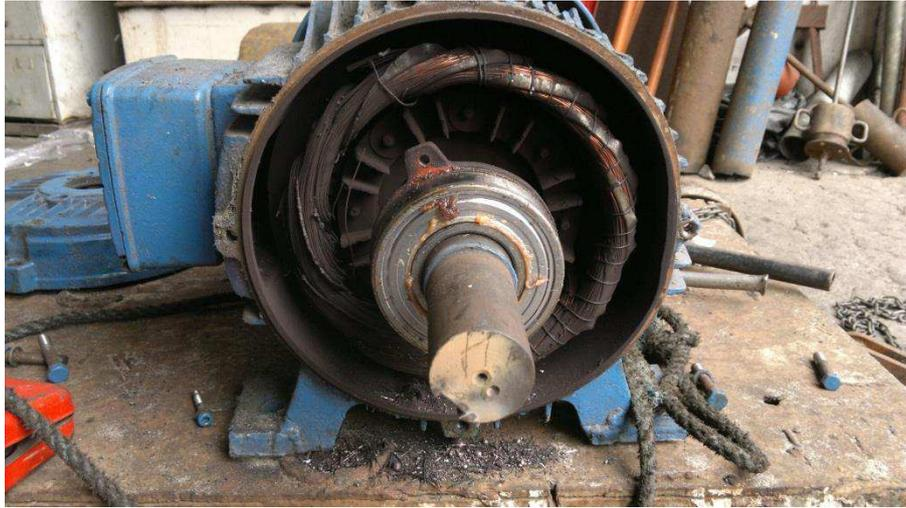
**Figura 4 – Motor de indução trifásico: eixo, rolamento e bobinado em estado carbonizado, demandando manutenção corretiva.**
