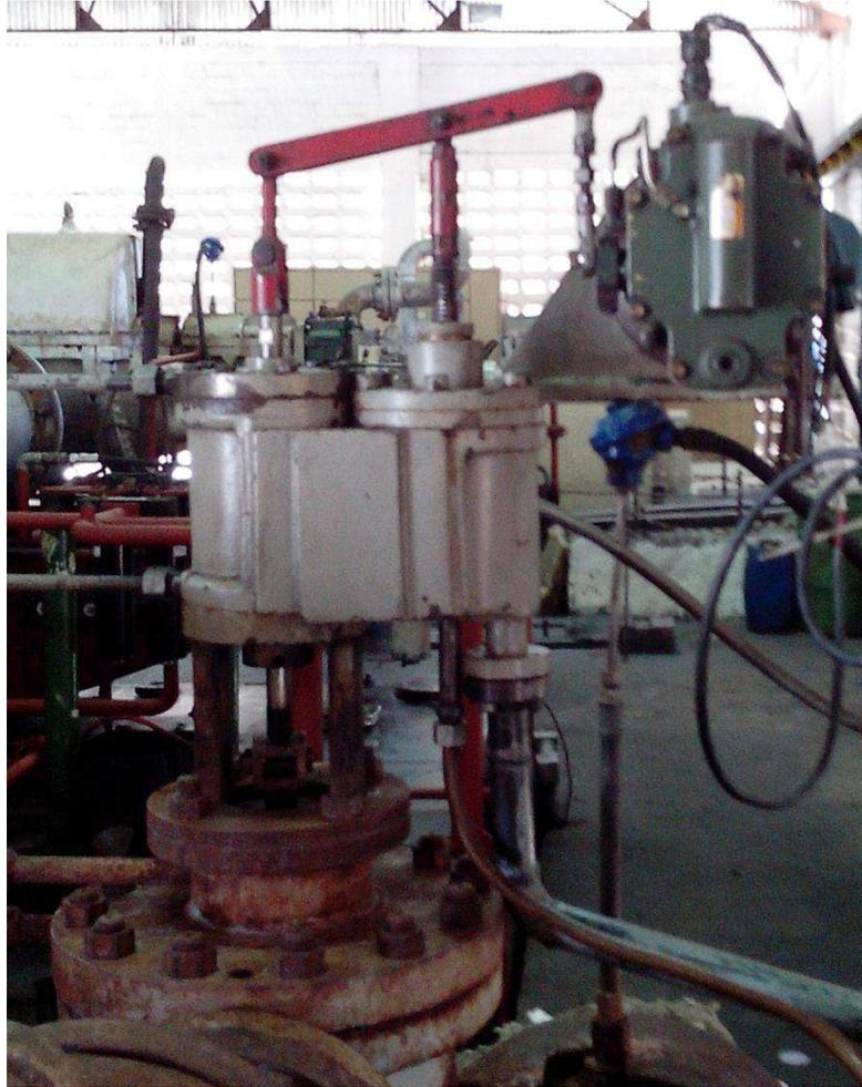
**Figura 15 - Atuador mecânico que regula a válvula de admissão de vapor.**
