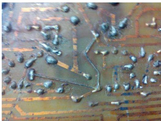
**Figura 40 - Verso da Placa com Trilhas Desgastadas e Recuperadas com Fio.**
