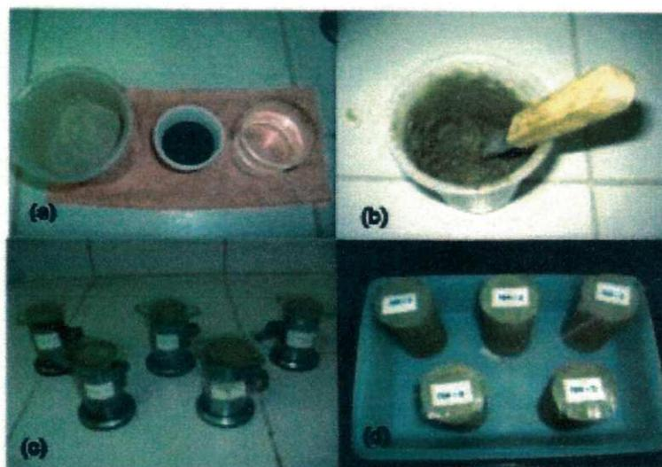
Figura 7: Confeção dos corpos de prova
