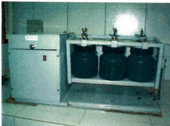
Figura 9: Agitador rotatório de frasco
