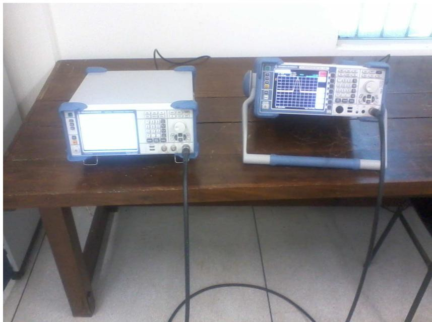
**Figura 12** – Montagem para medição de perdas nos cabos
