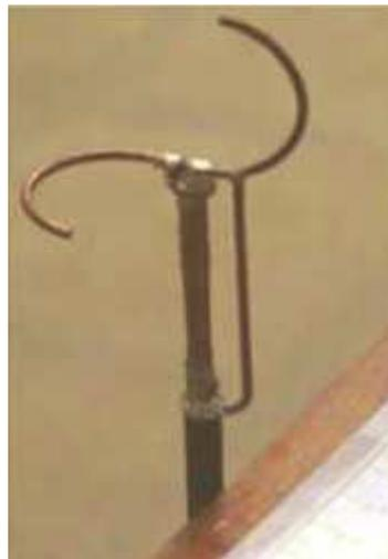
**Figura 14** – Antena dipolo de meio ciclo
