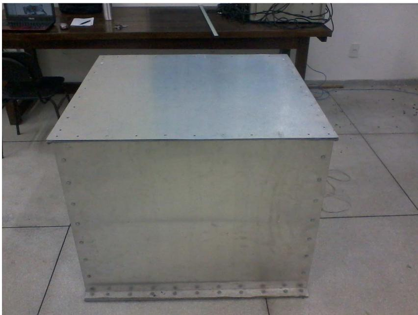
**Figura 1** – Câmara de reverberação disponível para testes
