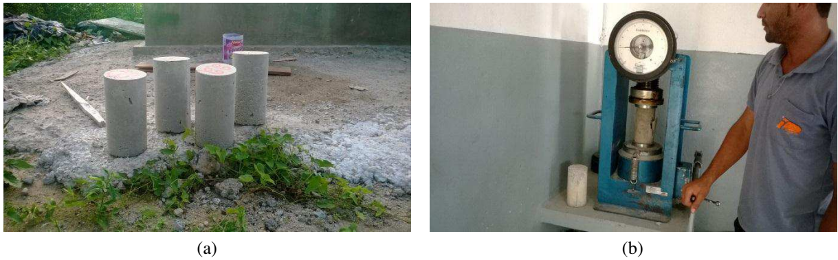
Figura 17. (a) Corpos de prova para ensaio de rompimento. (b) Ensaio de rompimento de corpo de prova.
