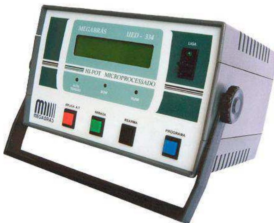
Figura 9. Fonte de tensão usada no teste de tensão aplicada.
