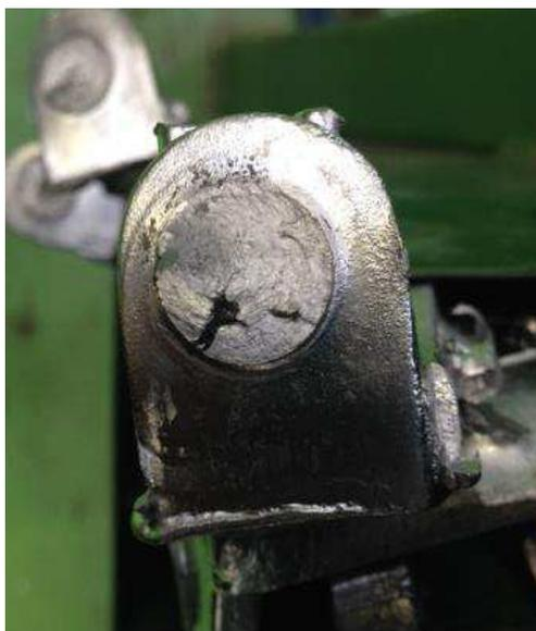
Figura 33: Ilustração da rebarba de plástico dentro da solda.
