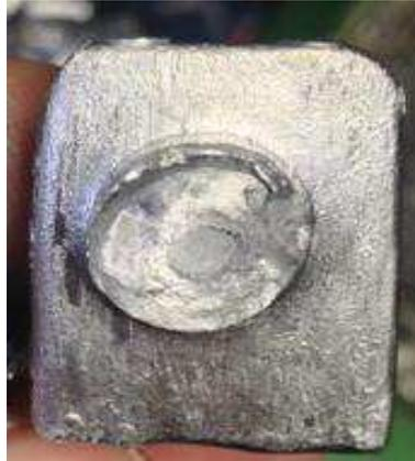
Figura 31: Ilustração do atraso no centro da solda.
