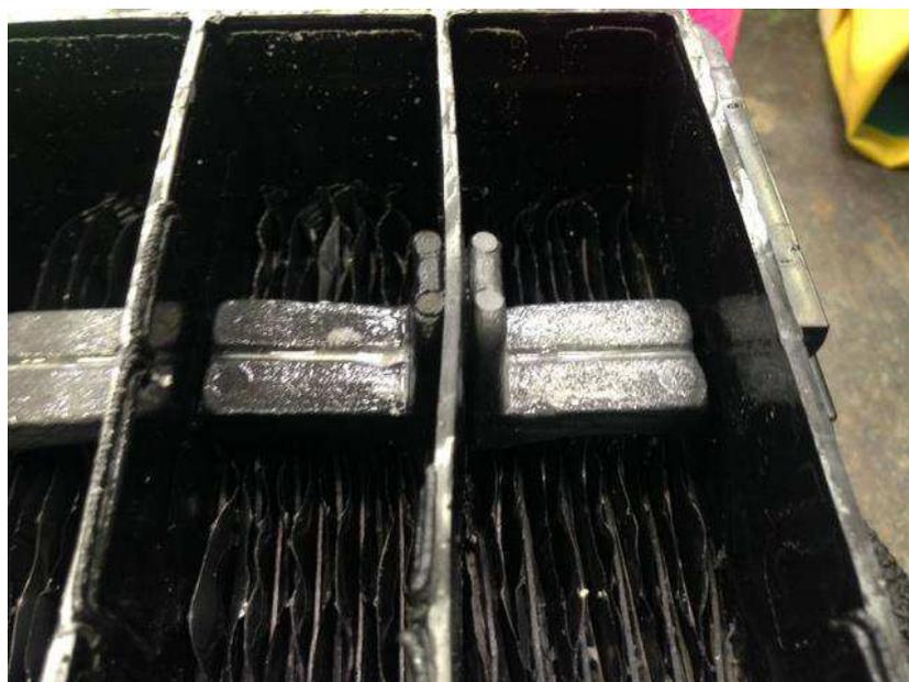
Figura 18: Imagem dos elementos conectados em série.
