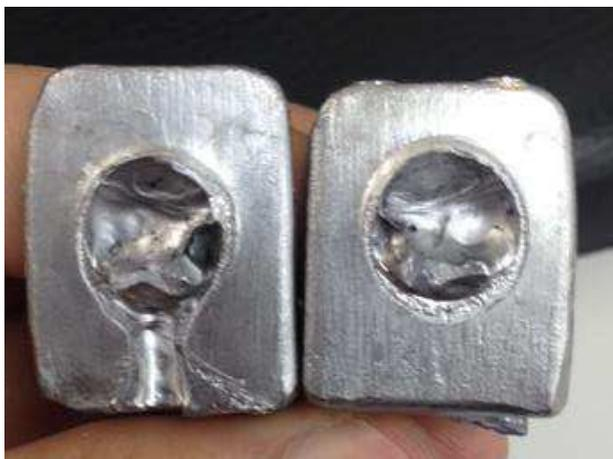
Figura 30: Ilustração do espirro na parte inferior da solda.
