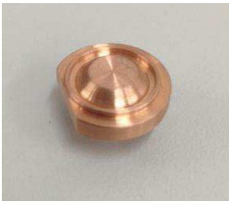
Figura 36: Eletrodo usado na solda intercell.
