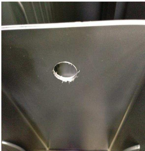
Figura 32: Imagem da rebarba na parede da caixa.
