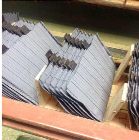
Figura 15: Imagem da placa negativa inserida no envelope e placa positiva fora.
