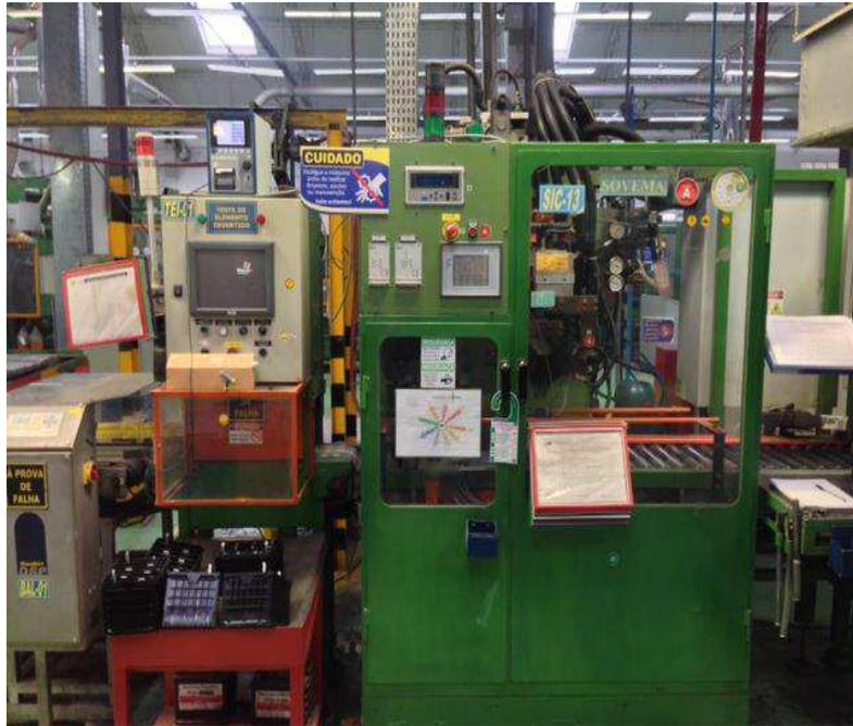
Figura 23: Imagem ilustrativa da máquina Sovema Welmatic 1000.
