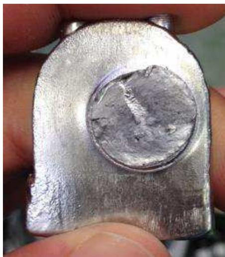
Figura 28: Ilustração do canal partindo do centro.
