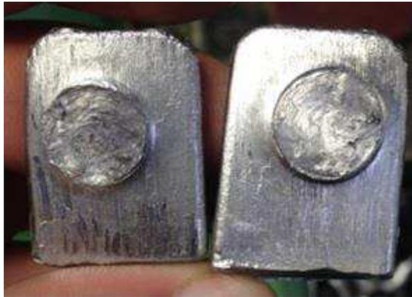
Figura 47: Imagem da solda abaixo limite de corrente.
