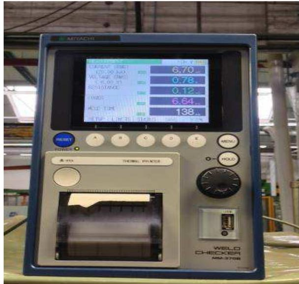
Figura 26: Imagem ilustrativa do Verificador de solda Miyachi MM-370B
