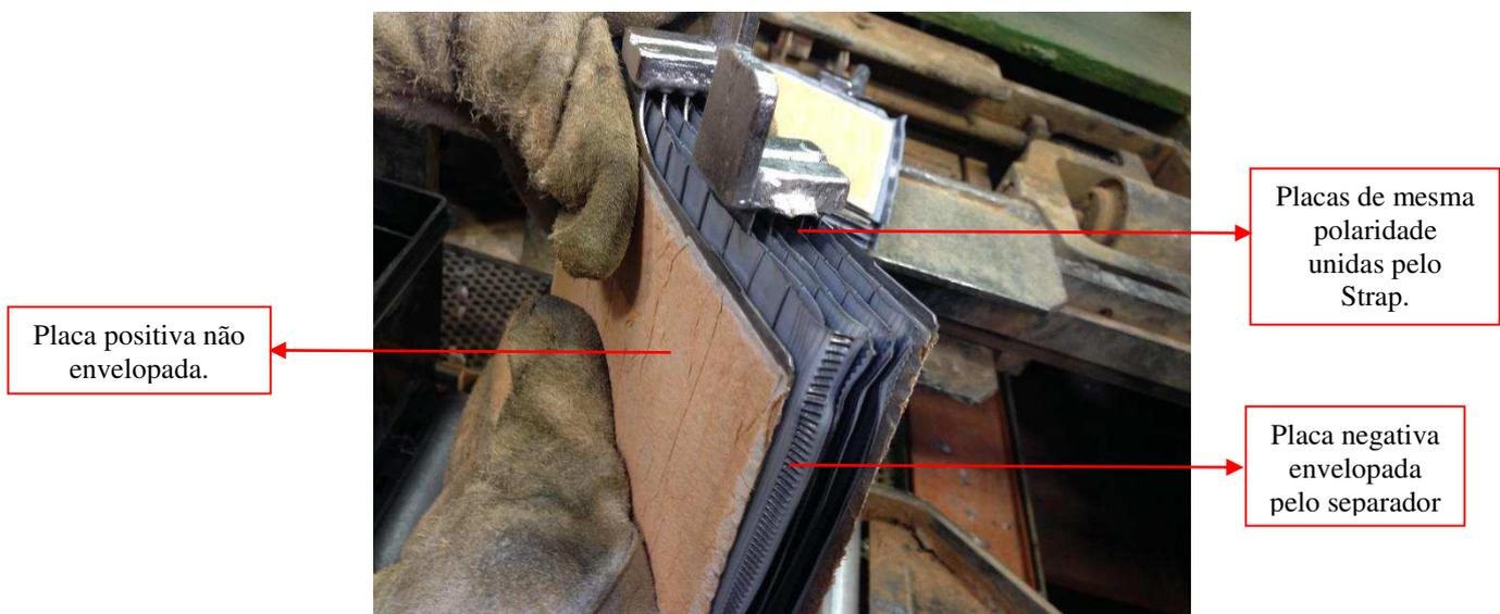
Figura 16: Imagem de um elemento da bateria.
