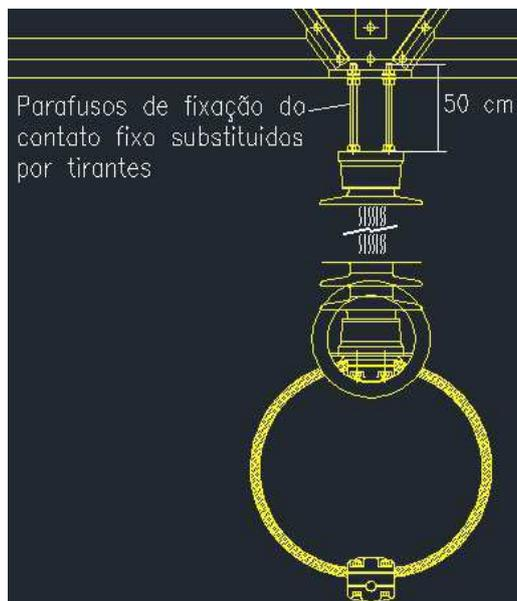
Figura 21 - Detalhe da substituição dos parafusos de fixação do contato fixo por tirantes.
