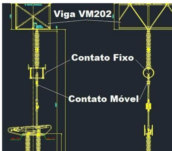
Figura 19 - Chave Seccionadora Vertical com identificação da viga VM202, dos contatos fixo e móvel, mostrando como a chave seccionadora ficaria se ocorresse o fechamento correto entre os contatos.
