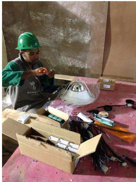
FIGURA 20 - BANCADA DE MONTAGEM DE LUMINÁRIAS
