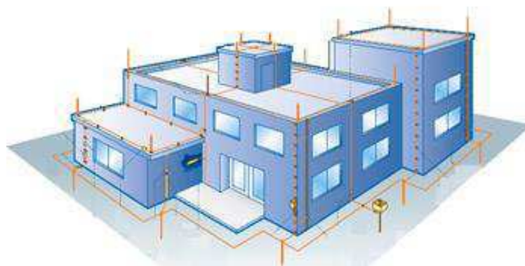
Figura 4.2 – Ilustração de SPDA tipo Gaiola de Faraday.
